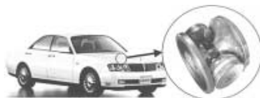
図1 ハーフトロイダルCVTとCVT搭載車
