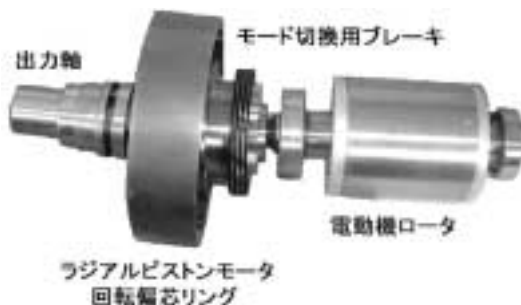
写真3 内部構造の写真 左がHMT、右は電動機
