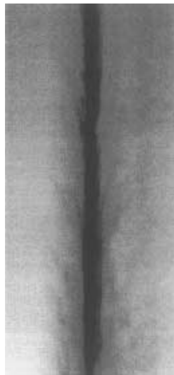
図6 300MPa, オリフィス径0.18mm, 噴出速度約550m/s 距離40～55mm時の噴流幅0.3～0.4mm
