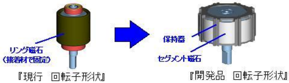
図6 磁石保持機による磁石固定
