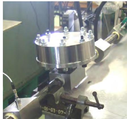
図 6 容量部の形状が扁平なヘルムホルツ型サイレンサ<sup>27)</sup>
