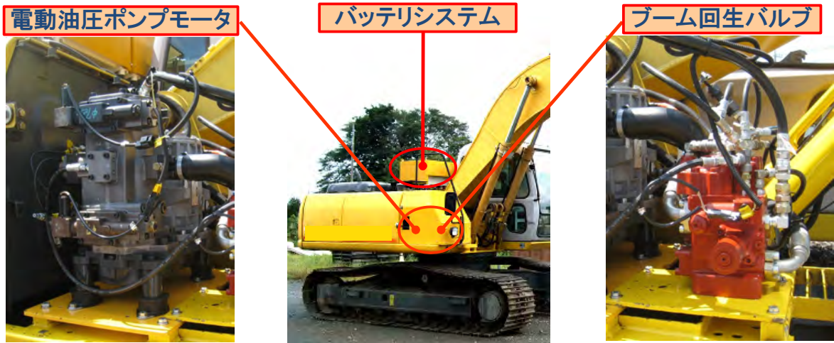
図2 実証機と搭載機器の一部
