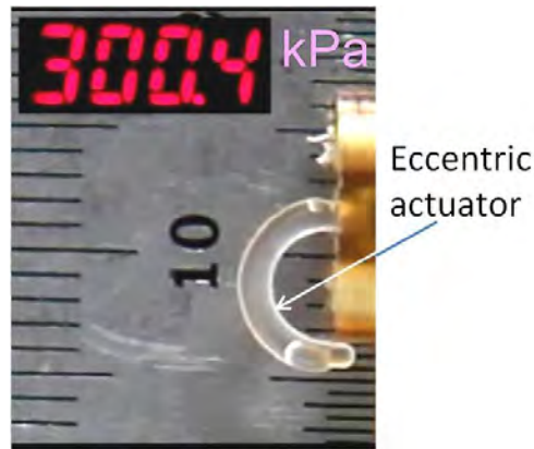
図3 偏心フィンガのECFポンプ駆動
