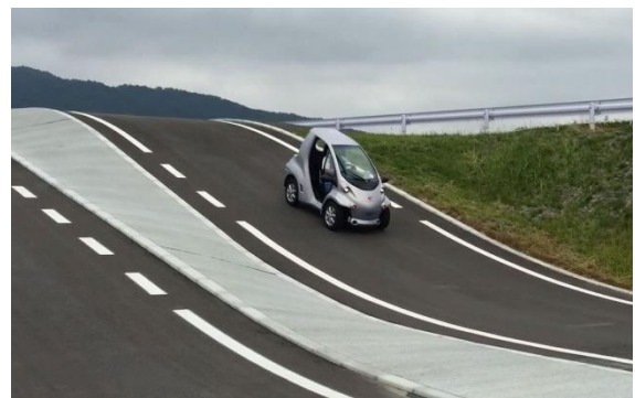
図6 MR流体ブレーキを装着した超小型EVが勾配30%坂道で一時停止している様子
