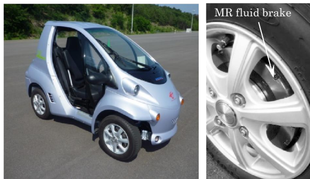
図5 MR流体ブレーキを装着した超小型EV(左)とその車輪(右)
