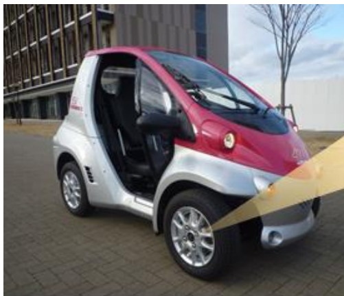
図 13 四輪にドライ MR 流体ブレーキを実装した超小型 EV
