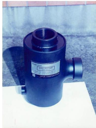
図2 旋回流を利用した気泡除去の原理と除去装置の一例<sup>3)</sup>
