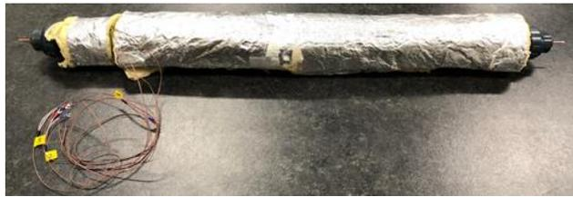
図3 過熱・冷却用試験管路構成と外形写真
