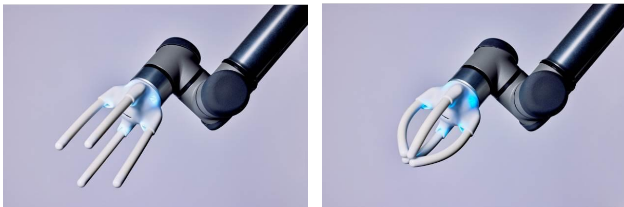
図 2 湾曲型ラバーアクチュエータを用いたソフトロボットハンド
