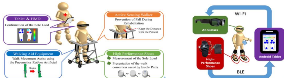
図 8 SCSRA を用いた安定歩行訓練システム
